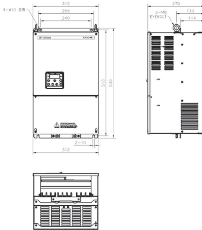
(4) Наружный размер моделей N700E-450HF, N700E-550HF (мм)
