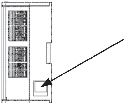
Рис. 1-2. Содержание таблички технических характеристик
