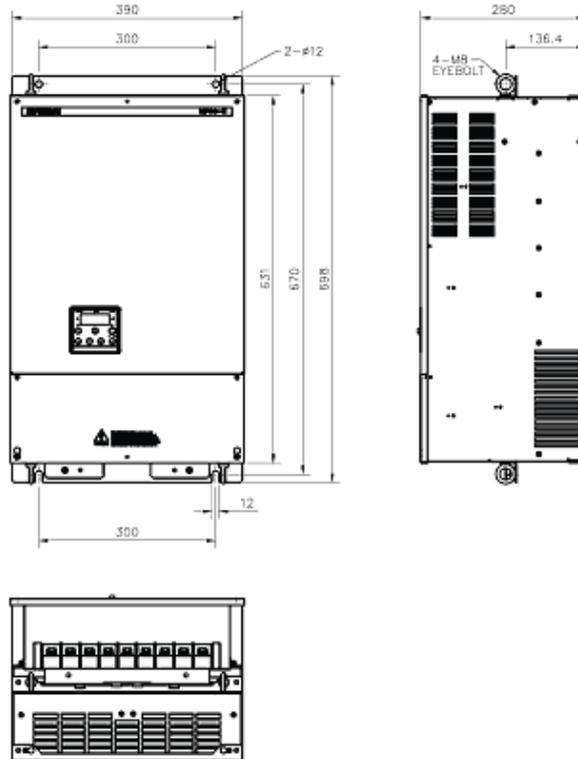
(6) Наружный размер моделей N700E-1100HF, N700E-1320HF (мм)
