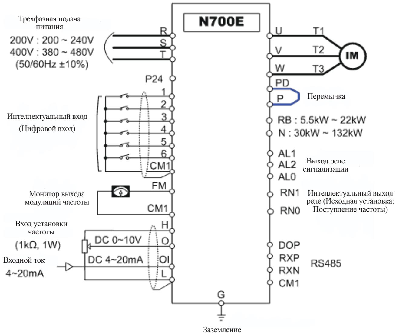
Рис. 3-1 Схема установки с помощью клемм управления
