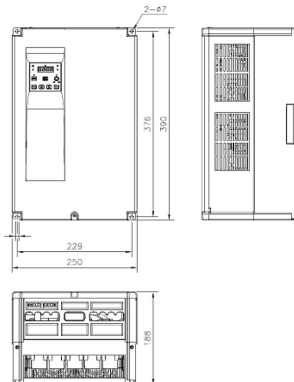
(3) Наружный размер моделей N700E-300HF, N700E-370HF (мм)
