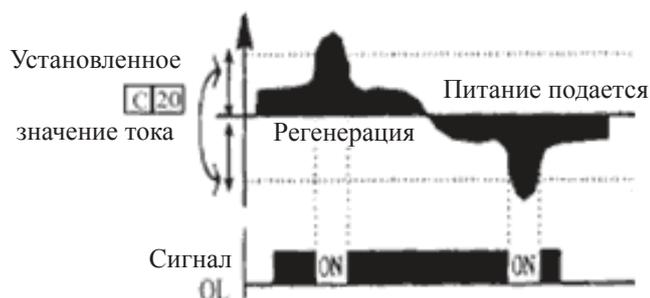
Когда ток на выходе превышает предустановленное значение, включается сигнал клеммы [OL].
