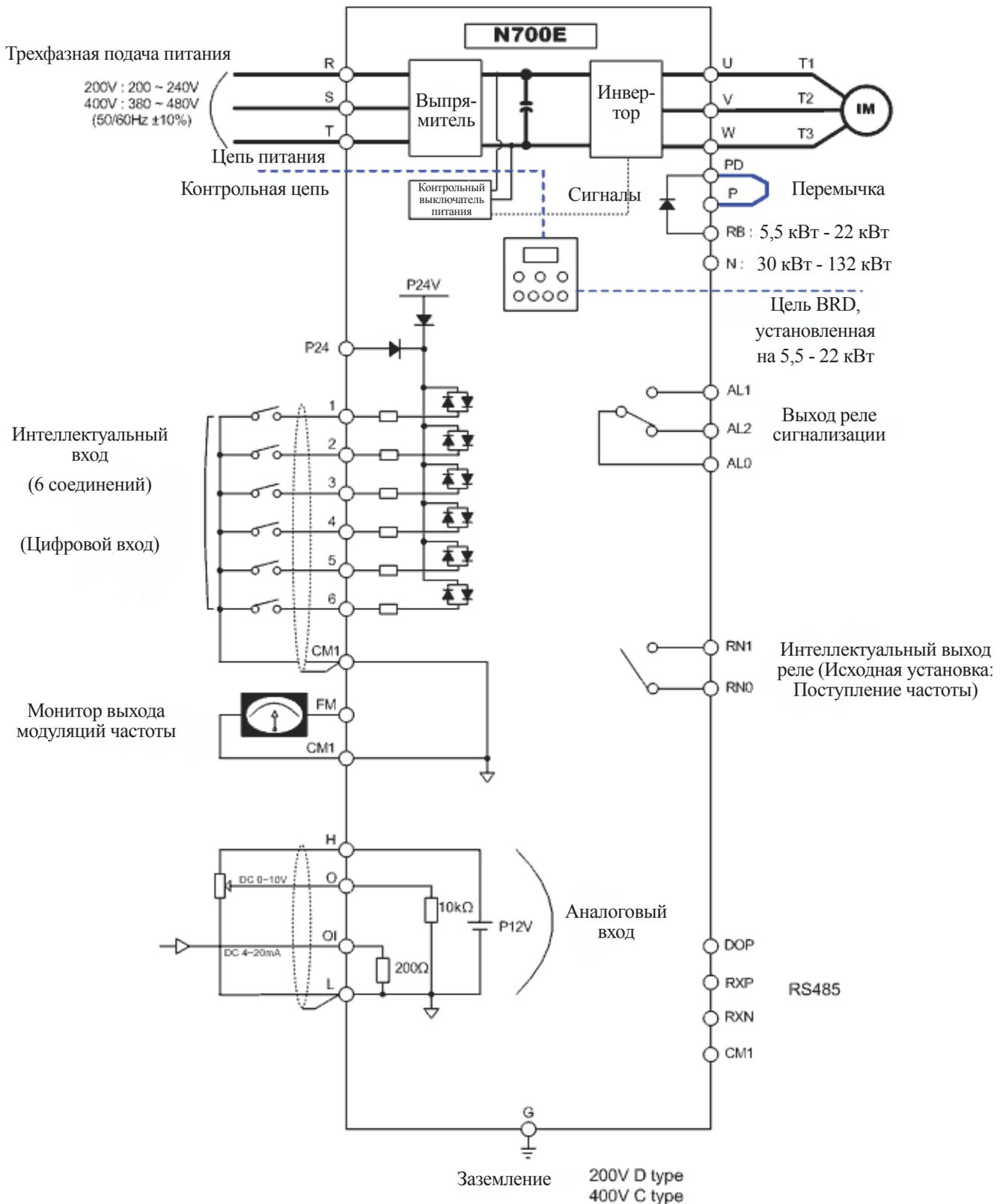
Рис. 2-3 Схема подключения клемм (стоковый тип)
