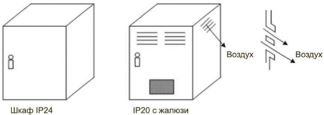
Рис. 1. Шкаф инвертора
