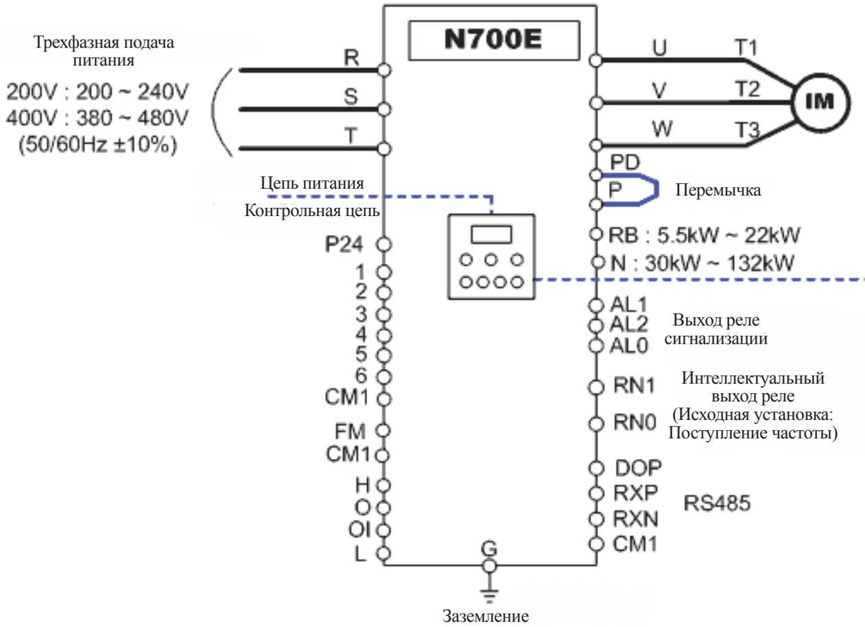
Рис. 3-2 Схема установки с цифрового пульта оператора
