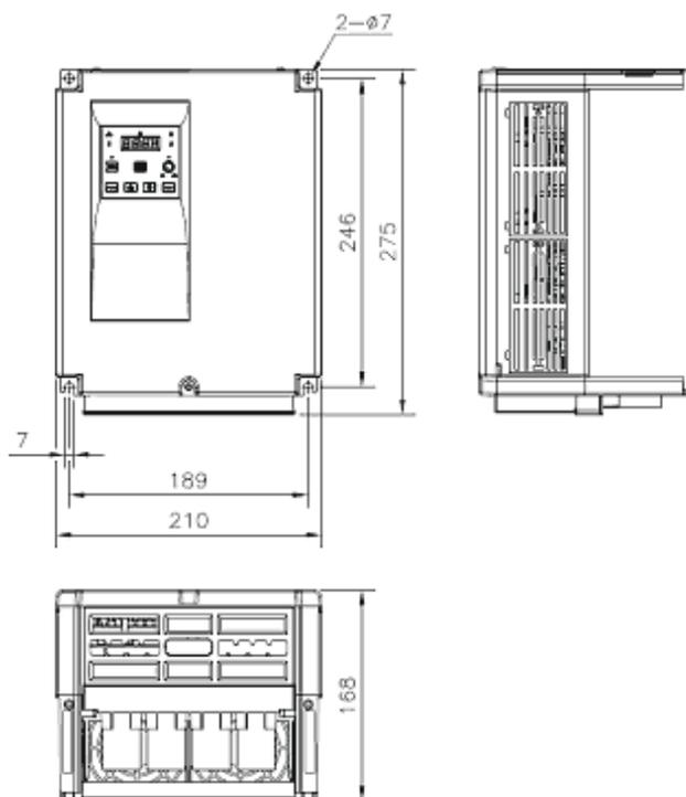
(2) Наружный размер моделей N700E-150LF/150HF, N700E-185LF/185HF, N700E-220LF/220HF (мм)
