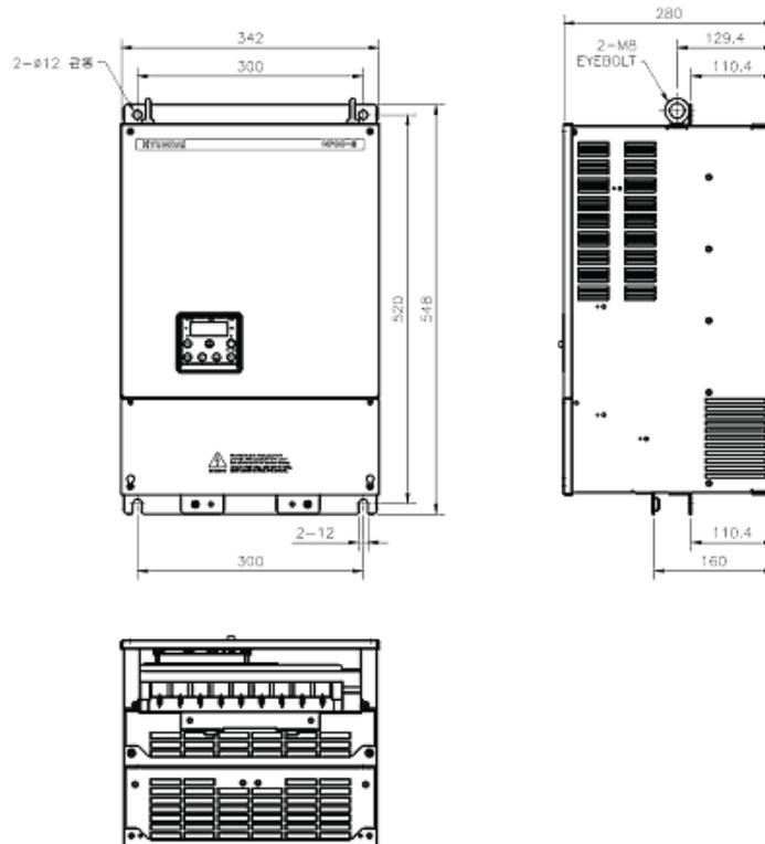
(5) Наружный размер моделей N700E-750HF, N700E-900HF (мм)
